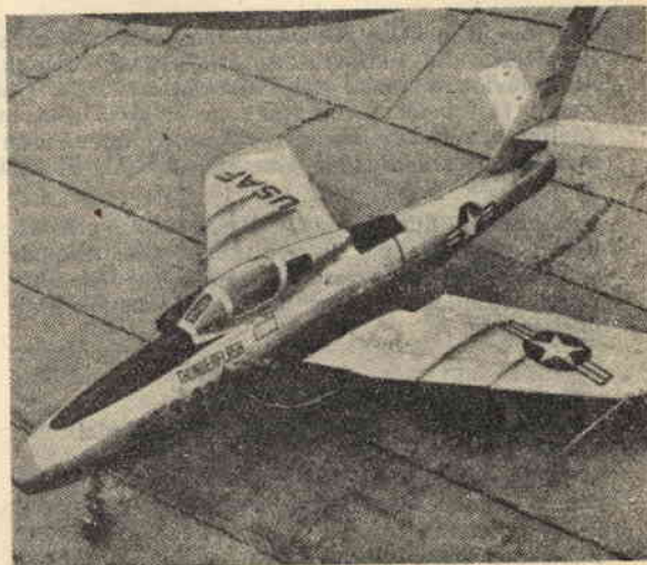
Fig. 2 - Il Republic's Thunderflash uno dei primi velivoli che utilizza il titanio per poter far fronte alla barriera termica.
