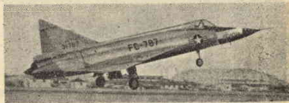
Fig. 3 - Il nuovo velivolo Convair F102 A capace di raggiungere il Mach 2 in fase di decollo.
